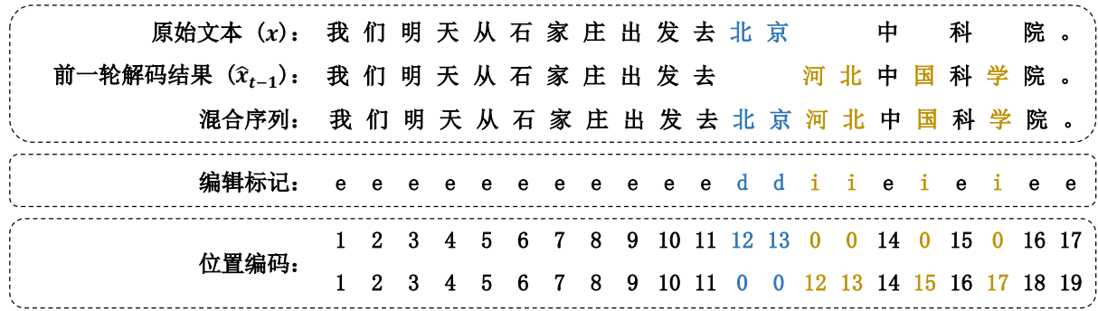
图 1: 基于序列对比的源信息融合。对于编辑标记, “e”、“d”和“i”分别表示相等、删除和插入。“0”表示位置编码中的填充。
