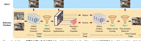
Figure 2. AirRoomの粗から細へのパイプライン. このパイプラインは、グローバルな文脈特徴をキャプチャしてトップ5の参照画像を検索するグローバル特徴抽出器から始まります。その後、インスタンスセグメンテーションが物体マスクを生成し、受容野拡張が物体とパッチの受容野を拡大します。物体特徴抽出器は、物体とパッチの両方の特徴を抽出します。物体認識に適したスコアリングメトリックを使用してトップ2の候補に絞り、細かい検索が最も適切な参照画像を識別します。
